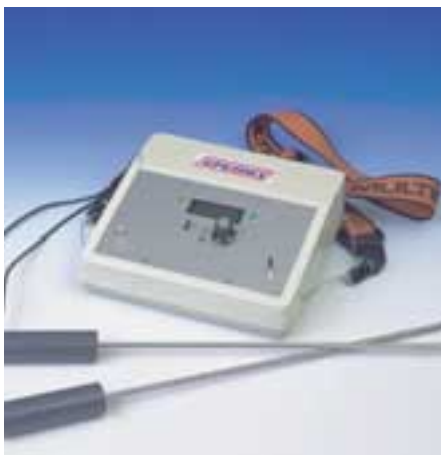
Das Differenzstrom-Meßgerät führt den Service-Techniker schnell punktgenau zur Leckstelle.
