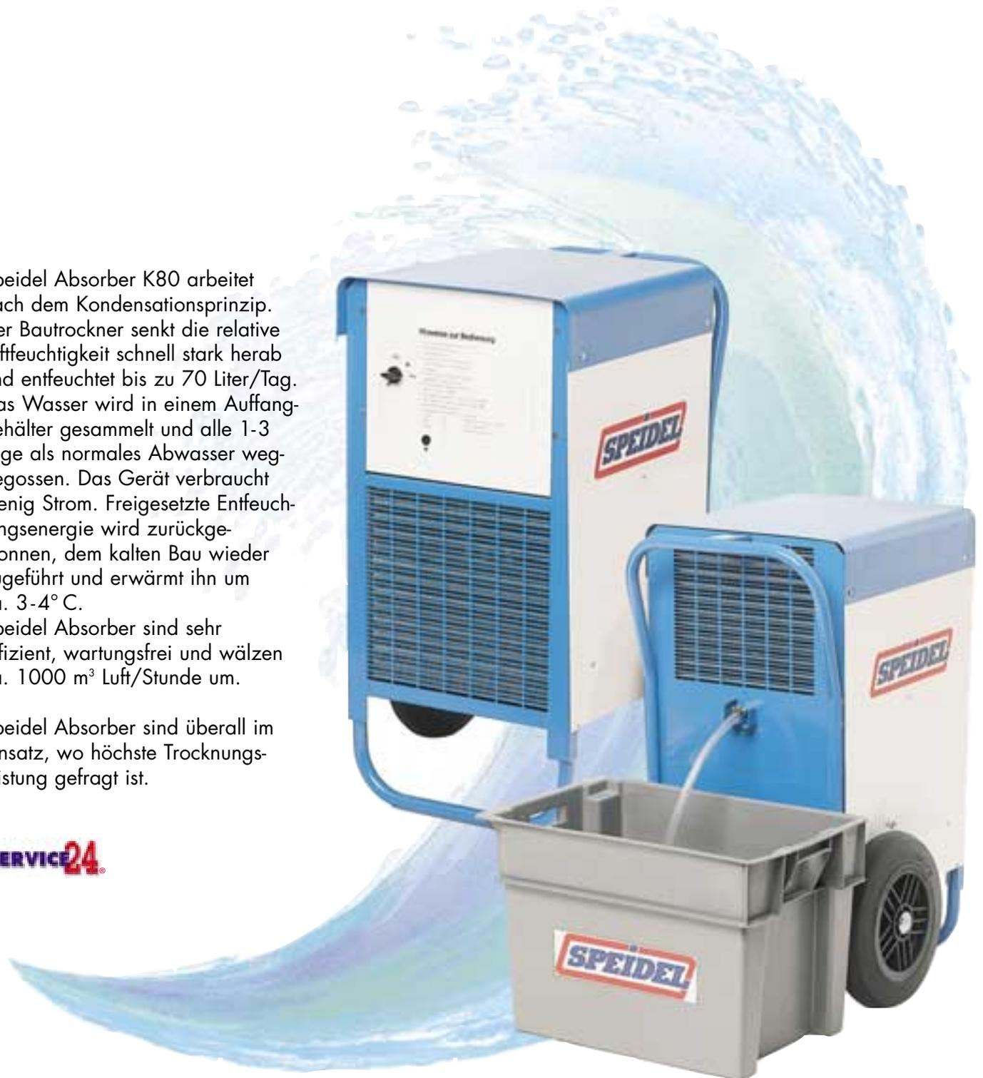
Absorber K80 werden zur Neubau-Trocknung eingesetzt. Sie regulieren temperaturbedingte Kondenswasserbildung in nicht genügend belüfteten Räumen. Sie verhindern Schwitzwasserbildung an Industrie-Anlagen und korrosionsgefährdeten Maschinen. Sie trocknen Warenlager nach Wasserschäden.
