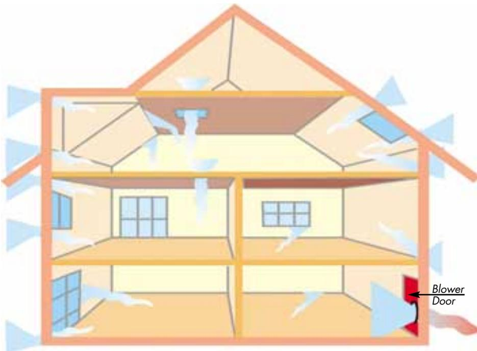
Besonders anfällig für Undichtigkeiten sind Gaubenanschlüsse, Laibungen von Fenstern und Dachfenstern, XEL-Bereiche von Decken-, Wand- und Bodenanschlüssen.
